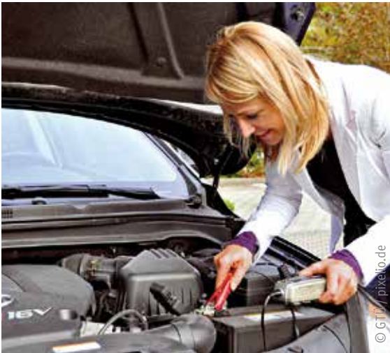
Niedrige Temperaturen im Winter setzen der Batterie zu, deshalb sollte ihre Leistungsfähigkeit überprüft werden.
